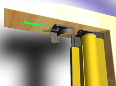
Fissare il supporto dx al vano superiore, inserire il cassonetto nel supporto inferiore e portarlo a contatto con il vano fino all'intervento dello scatto del supporto superiore, inserire il tappo a scatto. Fare la stessa operazione per l'altro cassonetto
