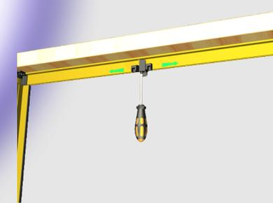
Inserire la guida al supporto e fissarla, inserire l'altra guida bloccandola con il ferma anta spostandolo al centro del taglio delle guide.
