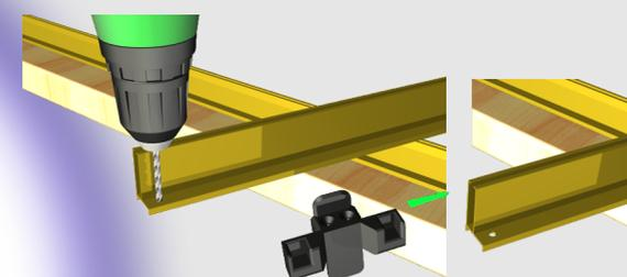
Praticare un foro a una delle guide poi inserire il blocco anta.
