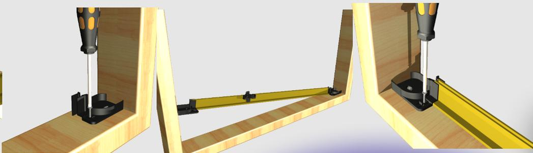
Fissare il supporto dx nel vano inferiore, inserire l'altro supporto alla guida e inserirla nel supporto fissato, portarla a contatto del vano poi fissarla tramite il supporto sx. NB inserire i tappi ai supporti prima di fissarli.
