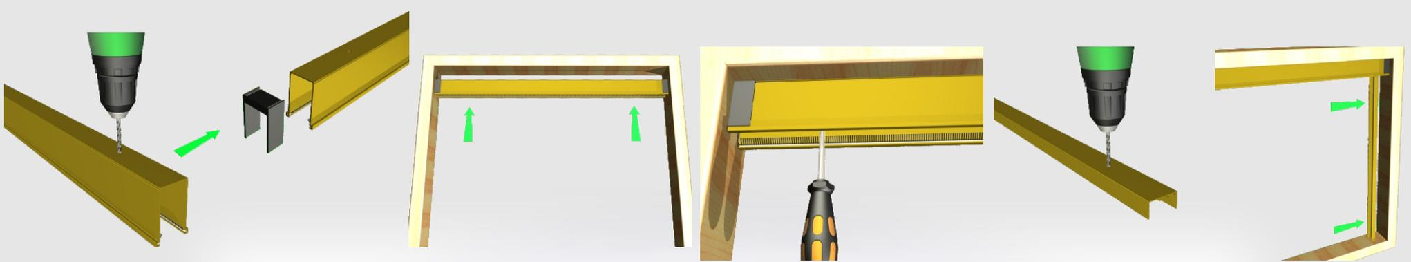
Guida sup. :Praticare dei fori per il fissaggio e fissarla al vano superiore
