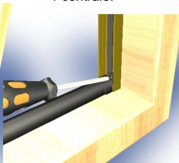
Inserire la guida sup. tra la sede del supporto e il profilo di chiusura e portarla a contatto con il vano e bloccarla tramite il ferma guida
