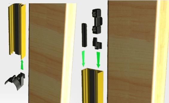
Inserire i ferma guida sup. e inf. nel profilo di chiusura.
