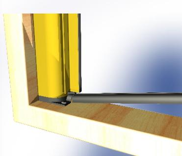
Inserire la guida inf. tra la sede del supporto e il profilo di chiusura e portarla a contatto con il vano e bloccarla tramite il ferma guida.
