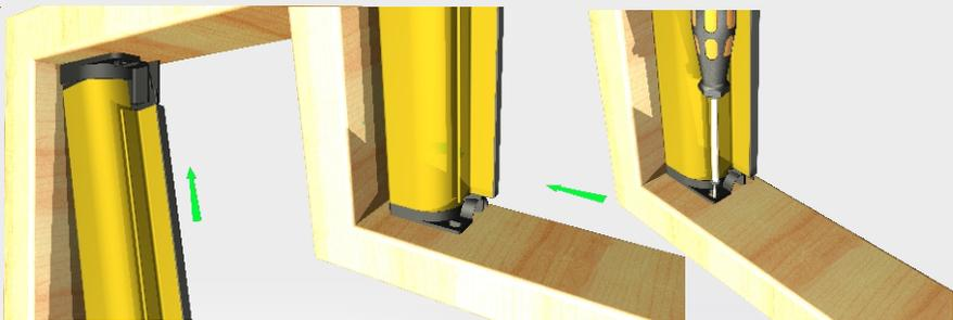
Inserire il cassonetto nel supporto e portarlo a contatto con il vano e fissarlo tramite il supporto inferiore.
