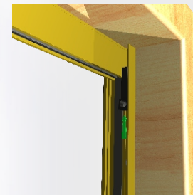
Inserire l'aggancio e i ferma guide nel profilo di chiusura
