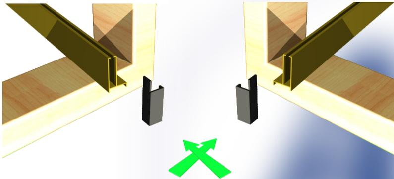
Inserire i sotto guida alle estremità delle guide inferiori
