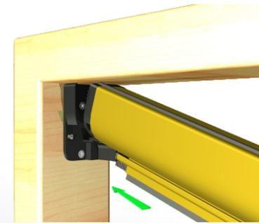
Inserire in diagonale il cassonetto nel supporto fissato e portarlo a contatto con il vano e fissare il supporto libero
