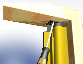
Fissare un supporto al vano e in seguito inserire l'altro supporto alla guida e posizionarla nel vano fissandolo.
