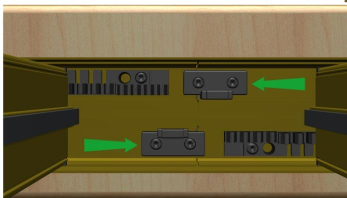
Ruotare le guide e portare le maniglie in avanti per allinearle poi spostare i giunti al centro delle guide per congiungerle, fissarli tramite i grani m 5 x 10
