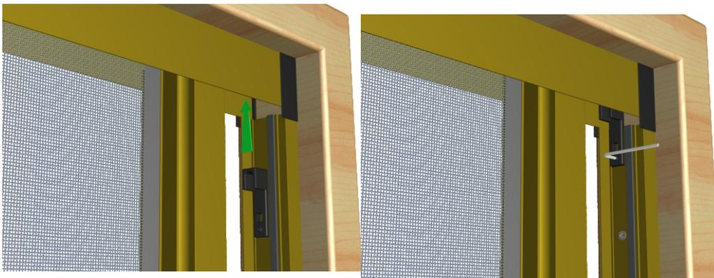
Bloccare la guida tramite il ferma con il grano m 5 x 6
