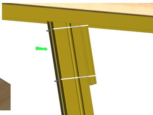
Inserire il pacchetto inclinato nel compensatore e portarlo a contatto con la giunzione, stessa operazione per l'altro pacchetto
