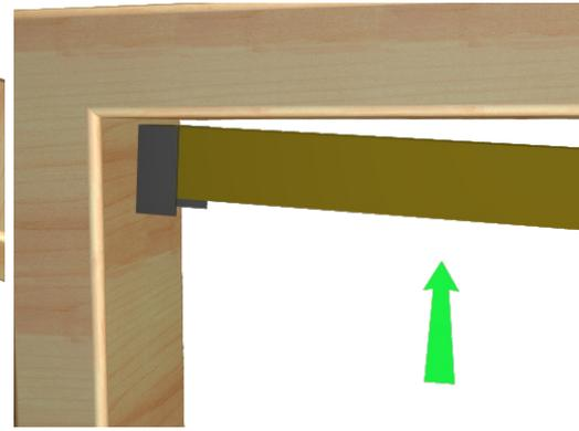
Praticare dei fori per il fissaggio al compensatore, inserire le cuffie di compensazioni e fissarlo al vano superiore
