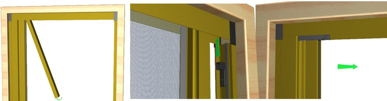
Ruotare la guida allineandola con la testata, portare in avanti la barra maniglia in modo che la guida resta in posizione. ( NB se all'apertura della barra maniglia si dovesse impuntare basta abbassare leggermente la guida dalla parte del cassonetto)
