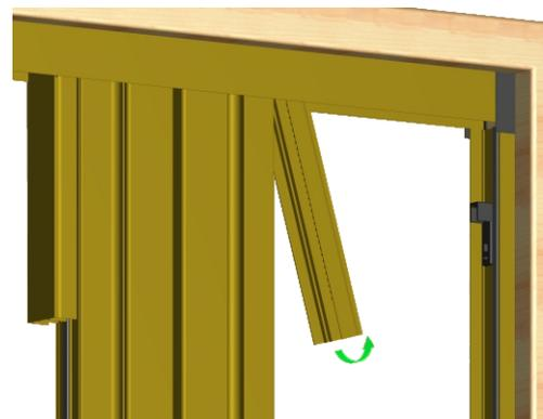
Tagliare le fascette di sostegno della guida, ruotare la guida all'interno del compensatore
