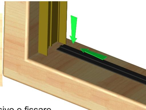
Togliere la protezione del biadesivo e fissare la guida al centro dei compensatori
