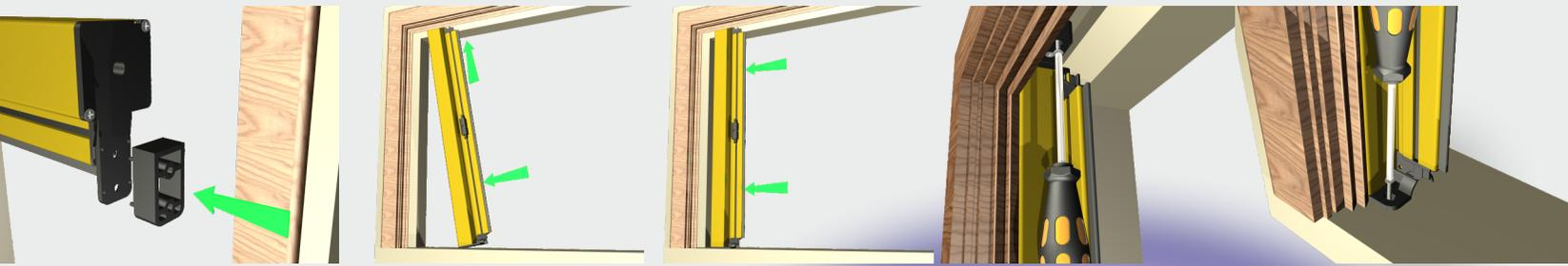
Inserire lo spessore al supporto sup. del cassonetto, posizionare in diagonale il cassonetto e portarlo a contatto con il vano fissare il cassonetto tramite viti nell'opposite sedi dei supporti.
