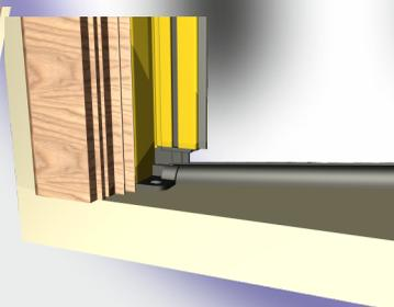
Posizionare la guida in diagonale tra l'invito del supporto e il profilo di battuta e portarla a contatto con il vano, spostare il fermo sulla guida e fissarlo
