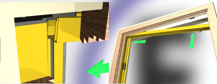
Inserire la guida in diagonale al supporto e portarla a contatto con il vano
