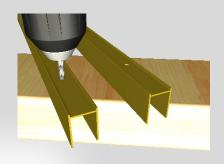
Compensatore a muro: Praticare dei fori per il fissaggio
