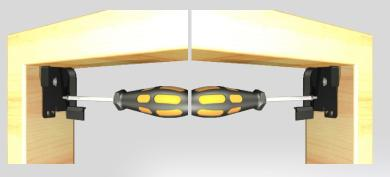
Fissare i supporti dx + sx nel vano superiore
