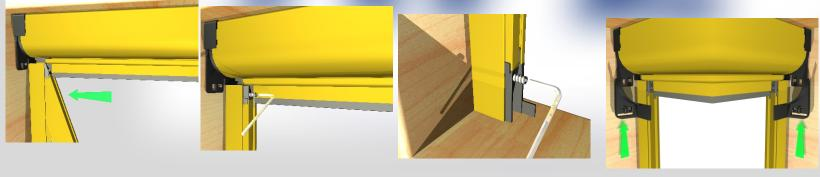
Inserire in diagonale la guida tra il compensatore e lo scivolo della barra maniglia e portarla in posizione. Per eventuale necessita' di regolazione delle guide agire sui grani presenti nell'invito e nell'aggancio.
