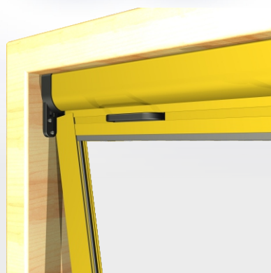
Inserire le guide tra l'invito guida predisposto sulle piastre e portarle a contatto del vano e fissarle. N.B. l'aggancio verso interno
