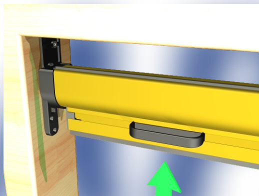
Posizionare inclinato il cassonetto e portarlo a contatto delle piastre fino all'intervento del fermo.
