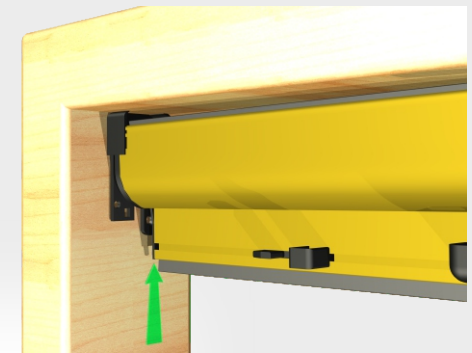
Inserire il cassonetto d'aprimita nel supporto chiuso poi nel supporto aperto
