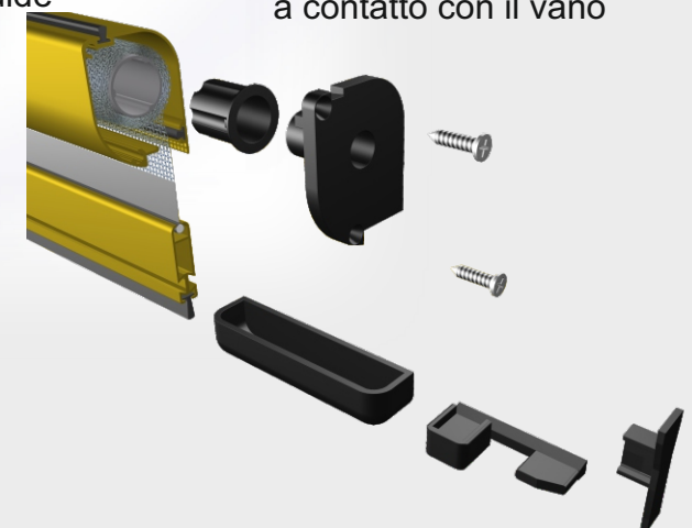
Inserire le guide e portare a contatto con il vano
