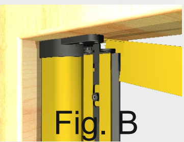
Fissare a circa 5 mm dalle estremità delle guide le piastrine di aggancio con grano m5 x 6.
